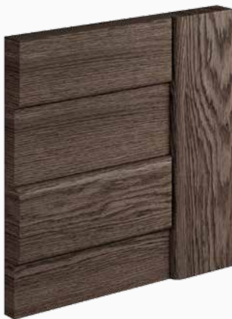
EGLE Spessore pannello 21 mm. Fresa raggio 9 mm con fascia in depressione di 7 mm.
