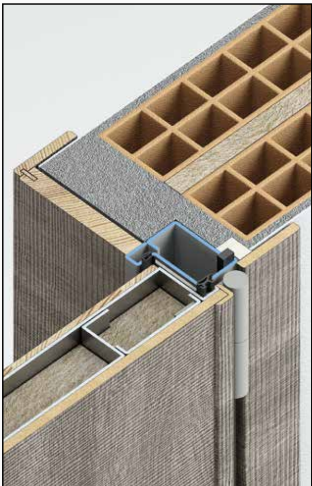
Cassamatta : BM, rifinitura muro interna con mostra, esterna con coprimazzetta in legno.
