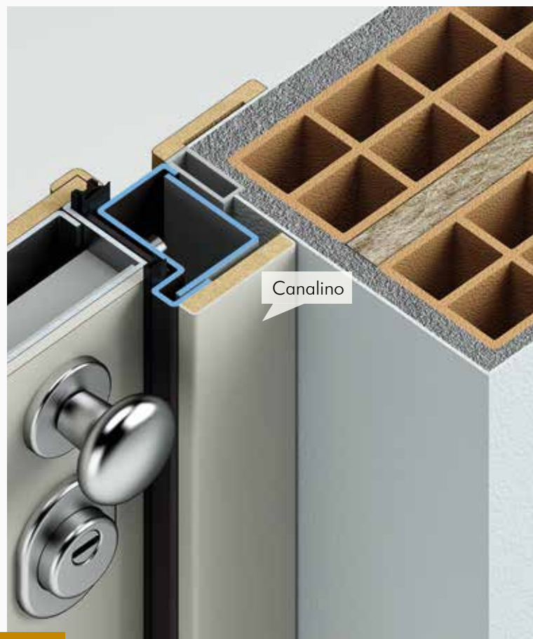
Rifinitura : CANALINO 70X11 ALLUMINIO Caratteristica : lo spessore di 11 mm è costante, la larghezza può variare fino a max 180 mm
