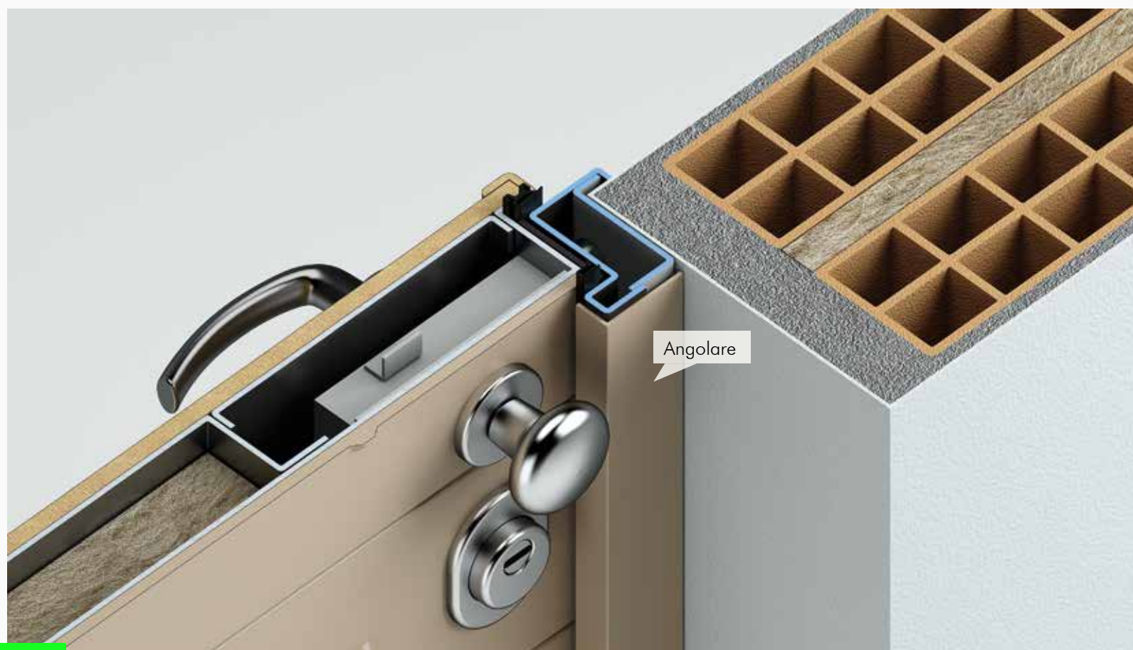
Rifinitura : ANGOLARE 50X15 ALLUMINIO Caratteristica : Specificare sempre la misura dei due lati (la somma dei due lati fino a max 200 mm) e indicare il lato da verniciare
