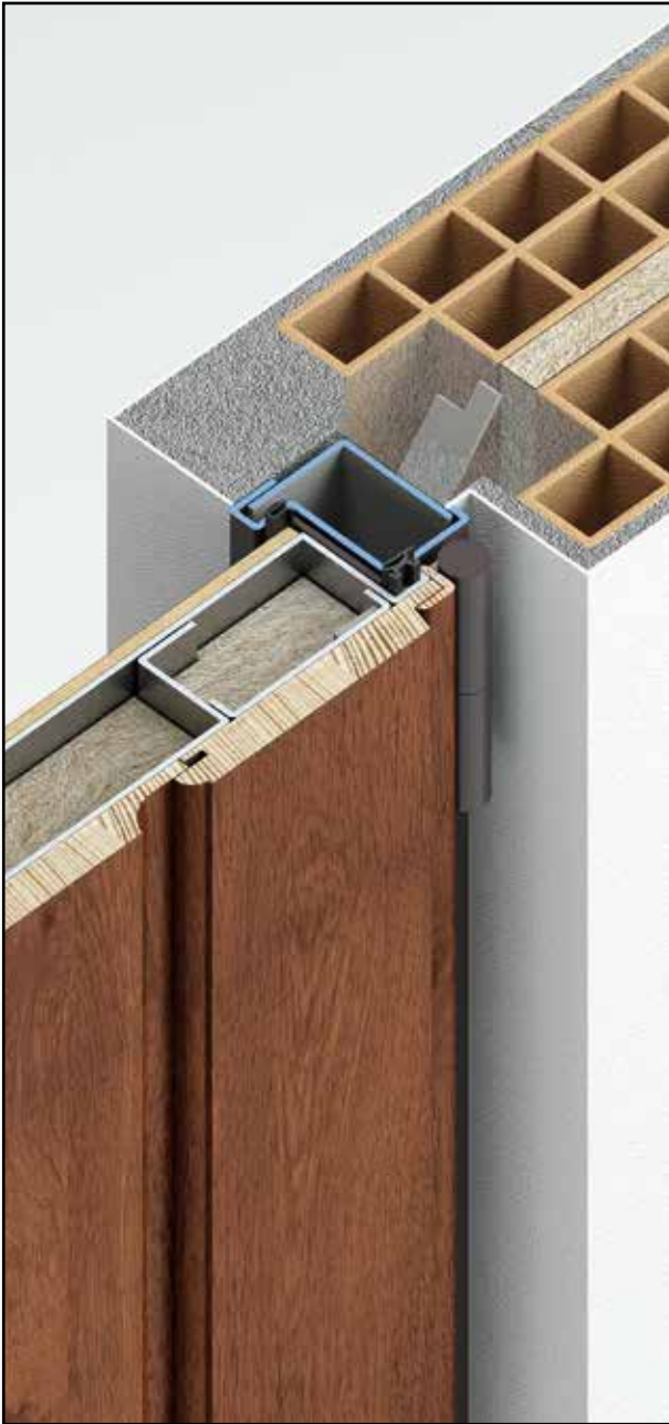
Cassamatta : C, rifinitura muro interna ed esterna ad intonaco.
