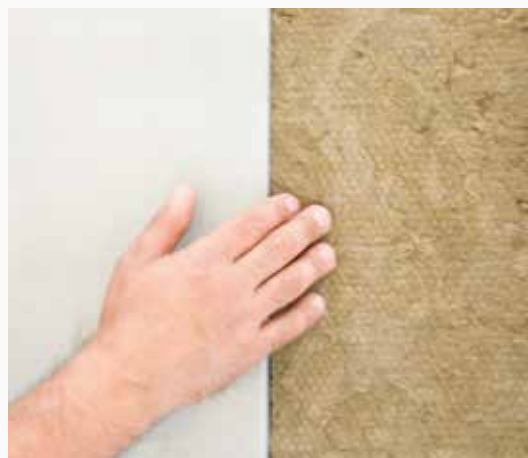
LANA DI ROCCIA inserita all'interno della scocca.
