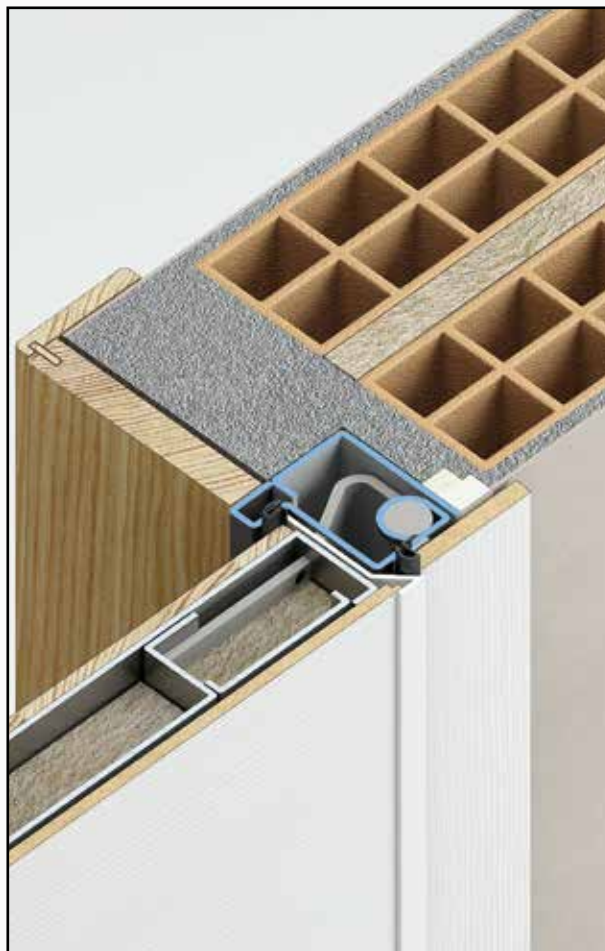
Cassamatta : A, rifinitura muro esterna con coprimazzetta in legno.
